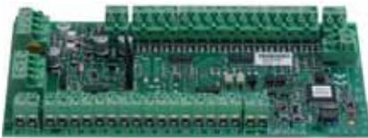
Die 32 Ausgänge des esserbus®-Kopplers können plus- oder minus-schaltend verdrahtet und programmiert werden. Jeder LED-Ausgang kann einen Strom von 10 mA treiben. Die Baugruppe ist werkseitig mit den erforderlichen Vorwiderständen zur LED-Ansteuerung bestückt. Weiterhin besitzt er einen Eingang für Lampentest.
