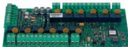
Die einzelnen Steuergruppen (Relais) werden wie zentraleninterne Ausgänge behandelt. So können sie im essernet®-Verbund auch von anderen Zentralen angesteuert werden. 11 Relais sind als Öffner oder Schließer frei programmierbar. Das 12. Relais ist als Schließkontakt ausgeführt.
