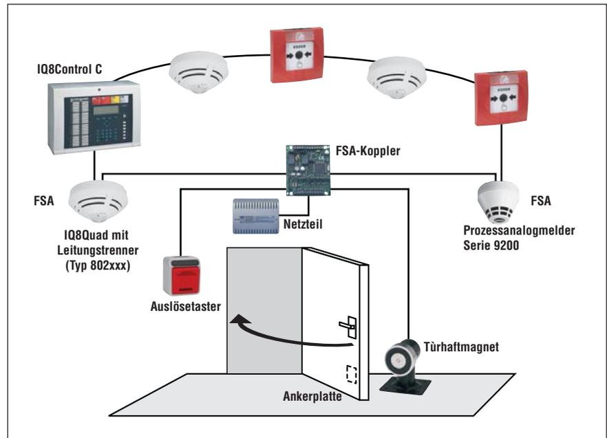
*FSA-Funktionalität durch den Einsatz der Prozessanalogmelder Serie 9200 oder der IQ8Quad-Melder als Auslöseelement auf dem esserbus®*
